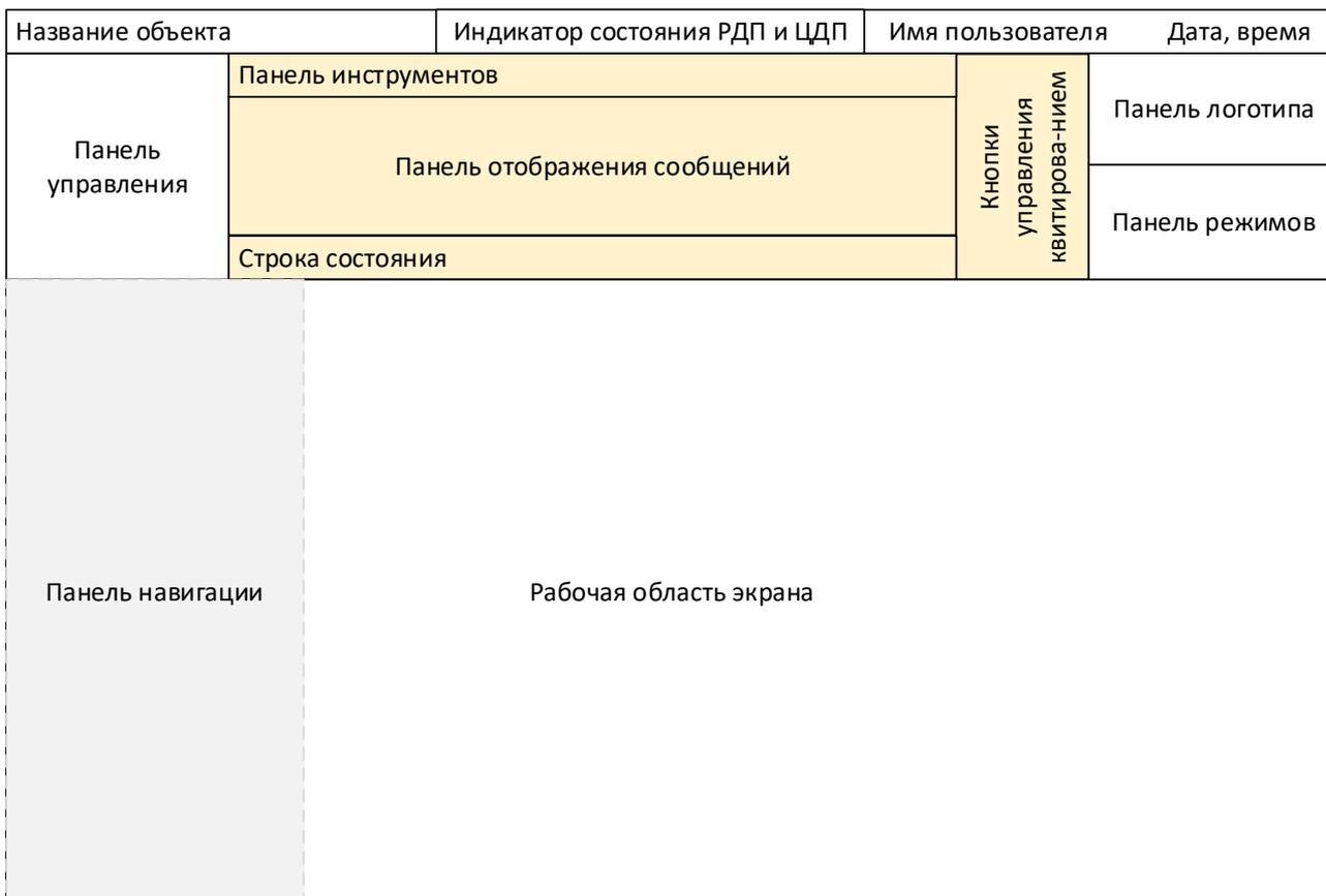
Рисунок 60 – Основной экран АРМ оператора
